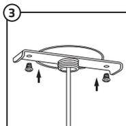
3 Mit Feststellgewinde und Montageschrauben fixieren
