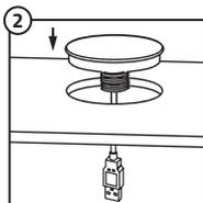
2 Qi Flat von oben bündig einsetzen
